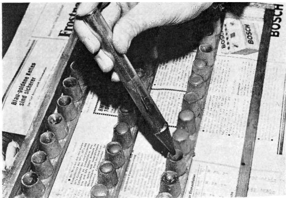
Рис. 51 — Деревянные пробки с выемками заполняют воском
